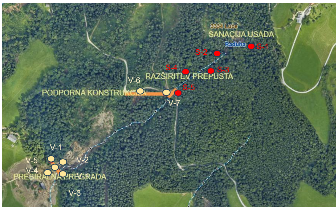
Priloga 2: Situacija plazu z okvirnimi lokacijami vrtin in sondažnih razkopov oz meritev z lahkim dinamičnim penetrometrom ter predvidenimi sanacijskimi ukrepi
